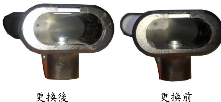
圖3 支撐腳支架頂端端視圖
