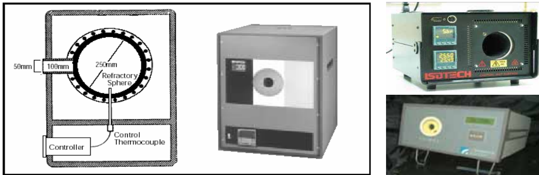
圖 2. 人工黑體(黑體爐)的外觀—耳溫計校正器
