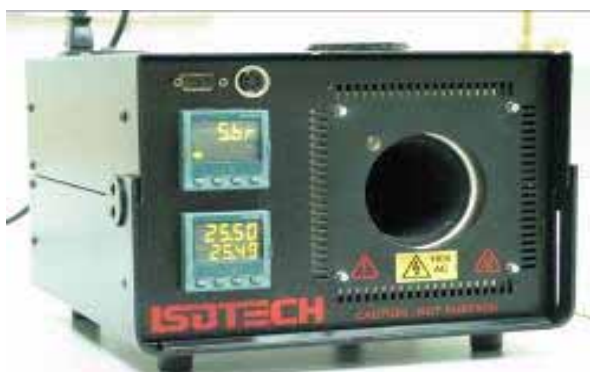
人工黑體(黑體爐)的外觀—耳溫計校正器
