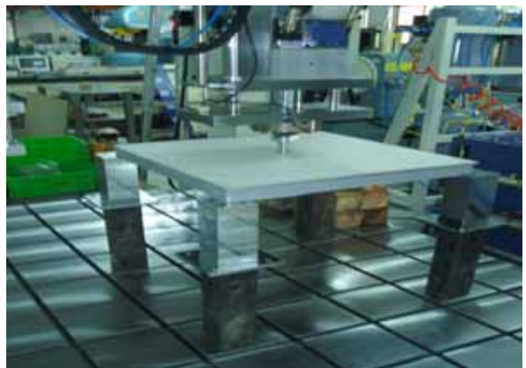
圖 4. 鋁合金高架地板荷重及撓度試驗
