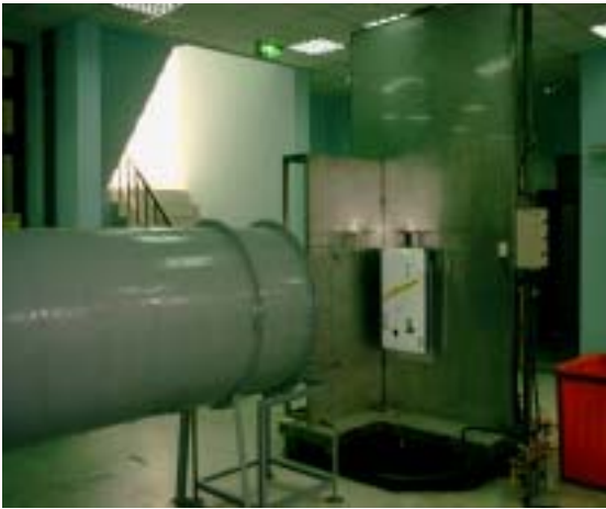
圖：屋外式燃氣熱水器有風狀態試驗裝置
