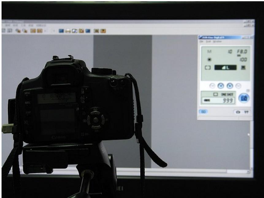
圖 3-2、FPD 解析度量測儀器組裝圖
