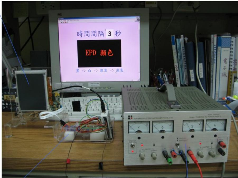
電子紙灰階切換控制電路
