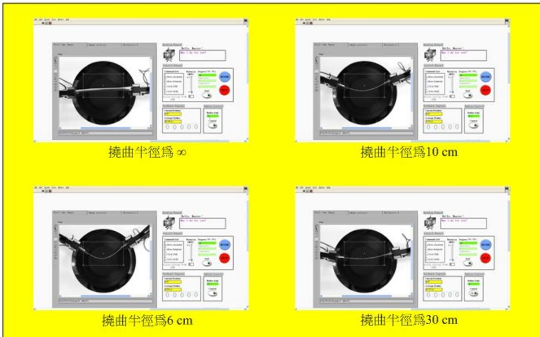
圖 33：控制不同之軟性顯示器撓曲半徑的實驗結果圖
